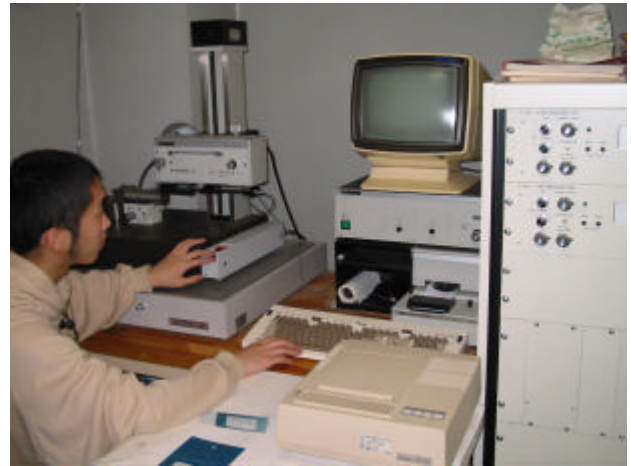
図2 . 表面粗さ測定機による粗さ測定
