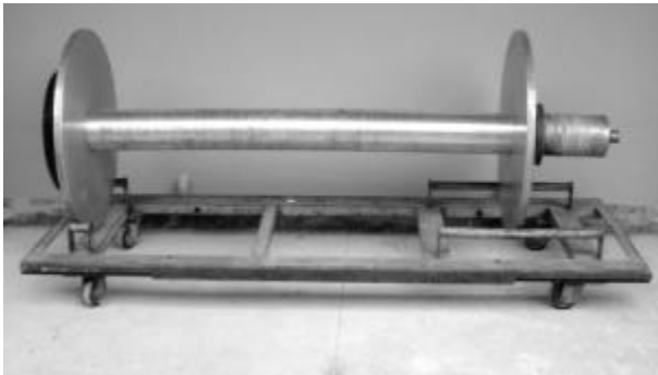
図1 変形したワーブビーム
